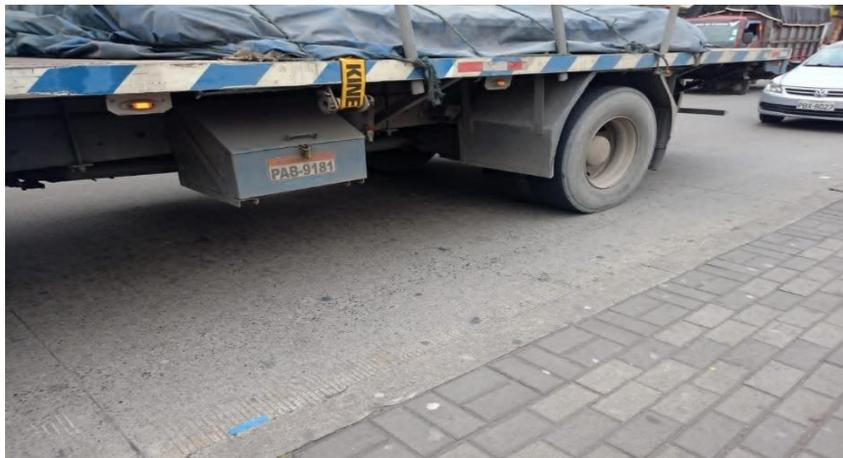
Foto 2. Vehículo pesado con neumáticos lisos
